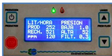
Al principio, la bomba de alimentación se activa y la presión de alimentación va incrementándose rápidamente.
