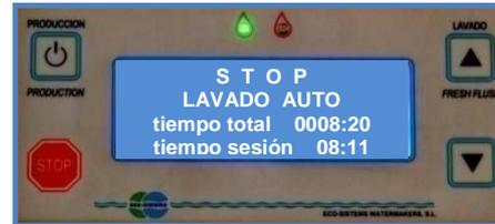
A fin de evitar un consumo excesivo de agua dulce, el sistema arranca y funciona al 40%-60% de la velocidad normal. La velocidad puede definirse durante la instalación. **Ver 4.6.1. Ajuste del caudal de lavado.** El ciclo de lavado se detiene al cabo de 2 minutos quedando programado un nuevo ciclo para dentro de 7 días.
